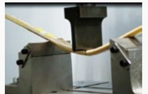
《 三点曲げ機による竹刀ピース破壊耐圧強度比較テスト結果 》
